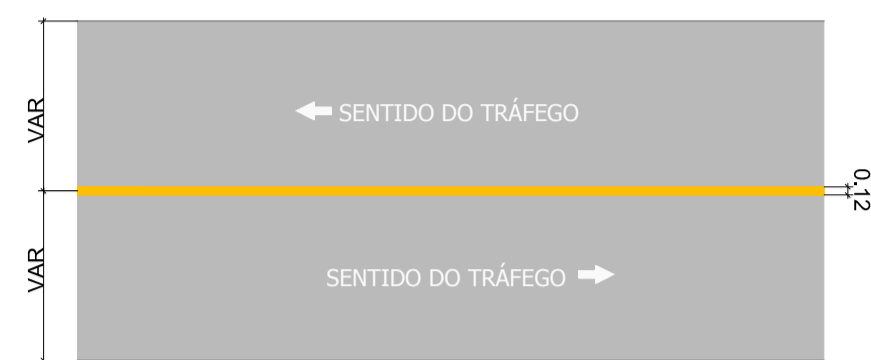
DETALHE - PINTURA (SINALIZAÇÃO HORIZONTAL)
