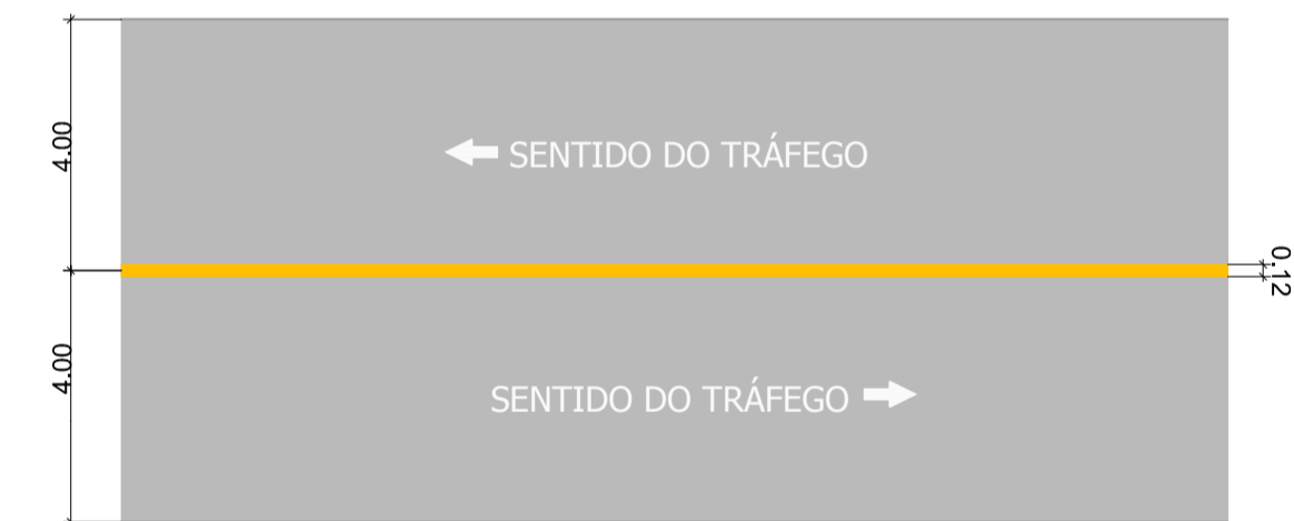
DETALHE - PINTURA (SINALIZAÇÃO HORIZONTAL)
