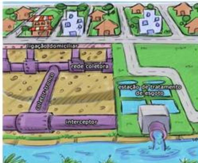
**Figura 3 – Sistema de Esgotamento Sanitário**
